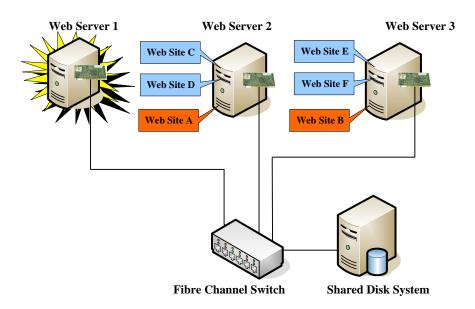
图 1-2 集群服务器失效时资源迁移示例
