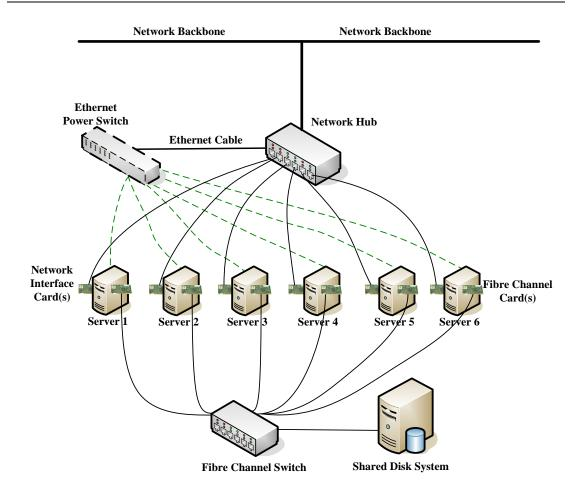
图 1-4 iSCSI 构造集群示例
