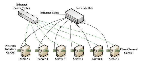
图 1-5 没有共享的磁盘子系统的集群示例
